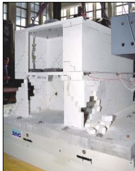
Slika 4. Model vrstne kuće M1-1c u fazi rušenja
