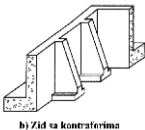
Slika 8. Konstrukcija za prijem seizmičkih dejstava na kraju mosta, prema [10]
