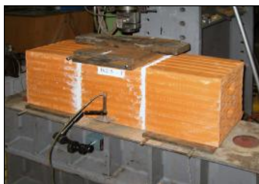
Slika 16. Ispitivanje uzorka na čisto smicanje prema EN 1052-3 u laboratoriji
